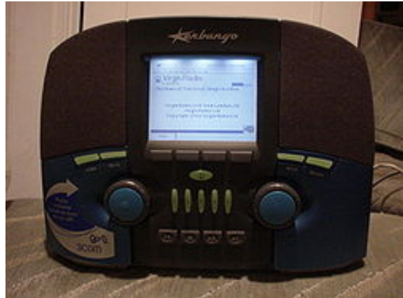
Slika 1.12. Na tržištu se mogu naći prijammnici za internetski radio kao samostalni uređaji uz koje nije potrebno koristiti osobno računalo
